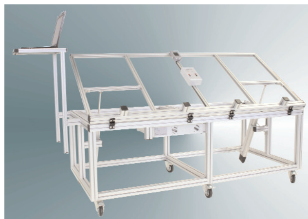
Ansicht: Prüfstand ohne PV-Module in 30° Stellung, der Prüftisch ist von 0° bis 80° motorisch verstellbar. In der Mitte des Prüftisches befinden sich der Sensor und das elektrische Anschlußfeld
