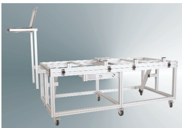
Ansicht: Prüfstand ohne PV-Module in 0° Stellung. Der PC ist nicht im Lieferumfang enthalten
