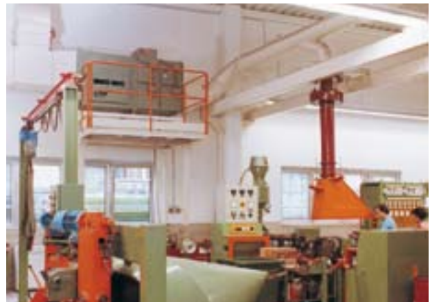
SMOG-HOG® SH-40/Tandem mit höhenverstellbarer Teleskophäube. Absaugung von Weichmacher-aerosolen an drei Kabelextrudern.
