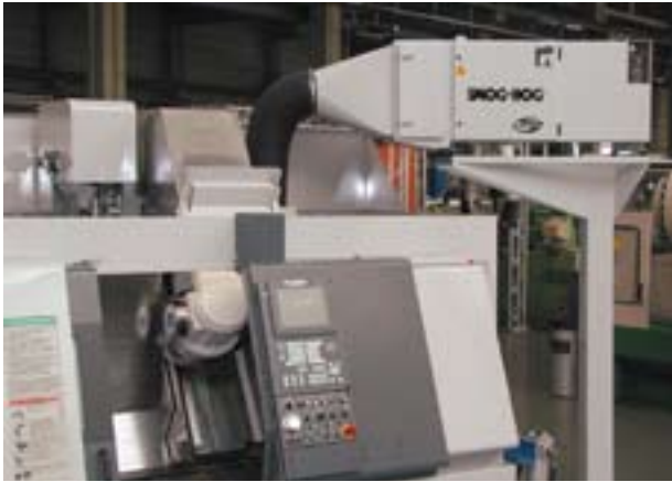
SMOG-HOG® mit Tropfenabscheider und variabler Nennleistung 800 - 2.000 m 3 /h zur Emulsionsnebelabsaugung.
