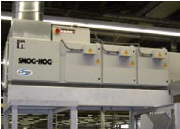
SMOG-HOG® SH-20/Tridem zur Abscheidung von Önebel und -rauch an einer CNC-Maschine.
