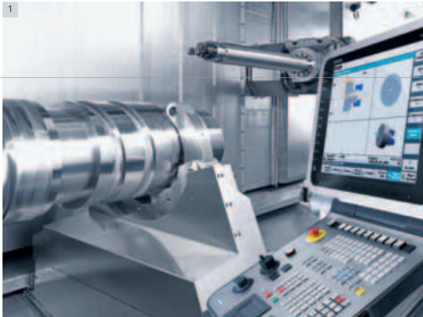
1| Siemens 840D DMG ERGOline® ControlPanel und ShopTurn 3G |2| Kurbelwelle für Großmotor \varnothing 350 mm \times 1.800 mm 3| Ventil für Schiffsdieselmotor \varnothing 550 mm \times 1.900 mm
