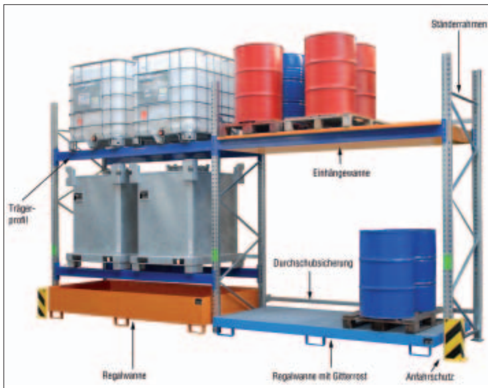
PR Set 1 für max. 12 x 200-l-Fässer bestehend aus: 2 x Ständerrahmen Typ PR-S 2000 2 x Trägerprofil Typ PR-T 2700-1 2 x Durchschubsicherung Typ PR-D 2700 1 x Regalwanne Typ RW-GR 2700-1 Zubehör: Anfahrtschutz (pro Stck.)
