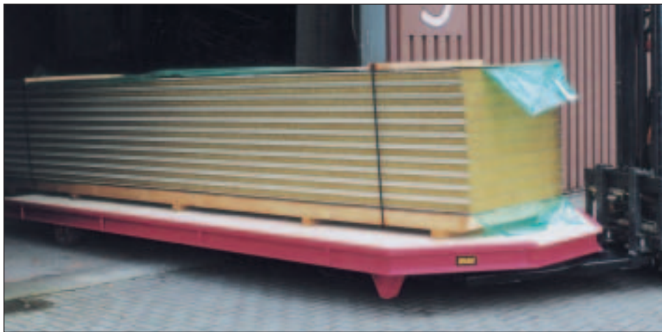
Transport von Langgütern; kleiner Wendekreis durch Direktaufnahme
