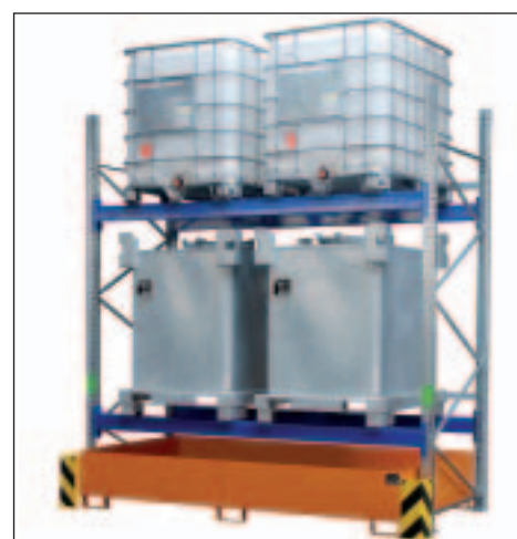
PR Set 3 für max. 4 x 1000-l-IBC bestehend aus: 2 x Ständerrahmen Typ PR-S 3000 4 x Trägerprofil Typ PR-T 2700-2 2 x Durchschubsicherung Typ PR-D 2700 1 x Regalwanne Typ RW 2700-3 Zubehör: Anfahrtschutz (pro Stck.)
