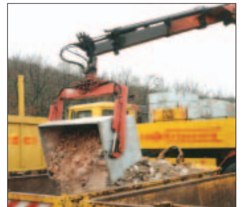
MC 1000 mit Greifzange, 150° Kippstellung
