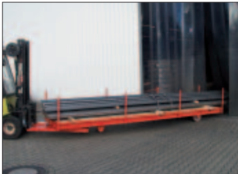
Transport von Langgütern; kleiner Wendekreis durch Direktaufnahme
