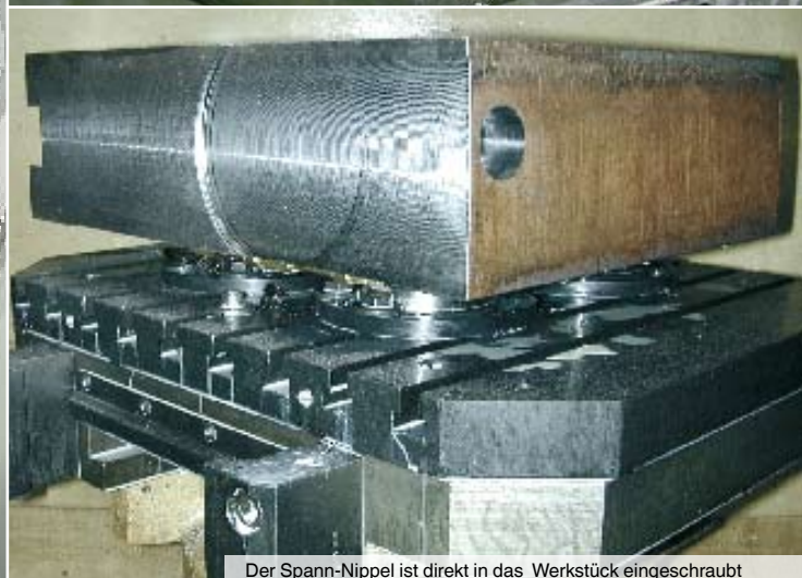
Der Spann-Nippel ist direkt in das Werkstück eingeschraubt
