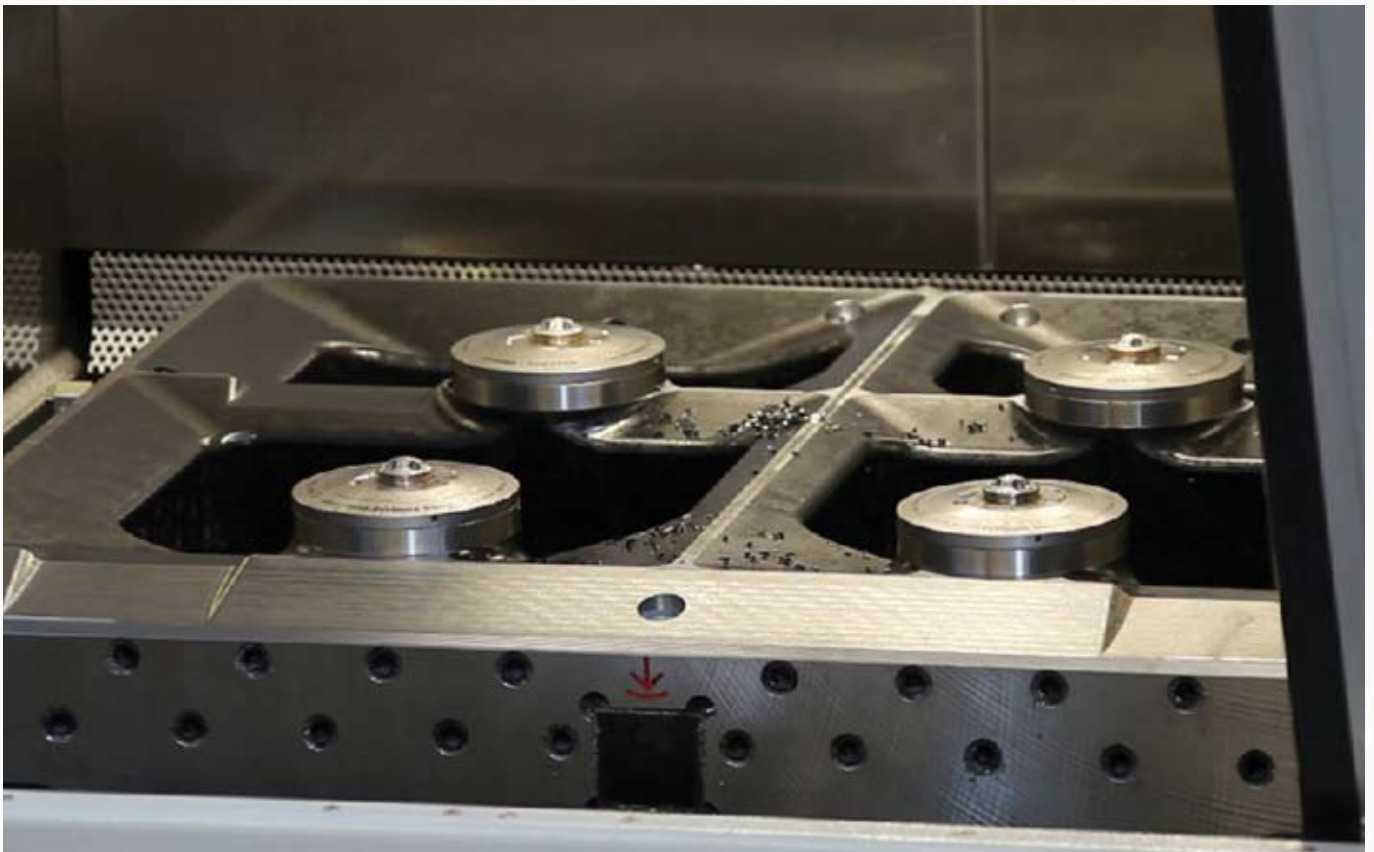
High-End Spannmodul „Turbine“ (Best.-Nr. 420919) im Einsatz in einem vollautomatisierten Fertigungsprozess mit Roboterbeladung.
