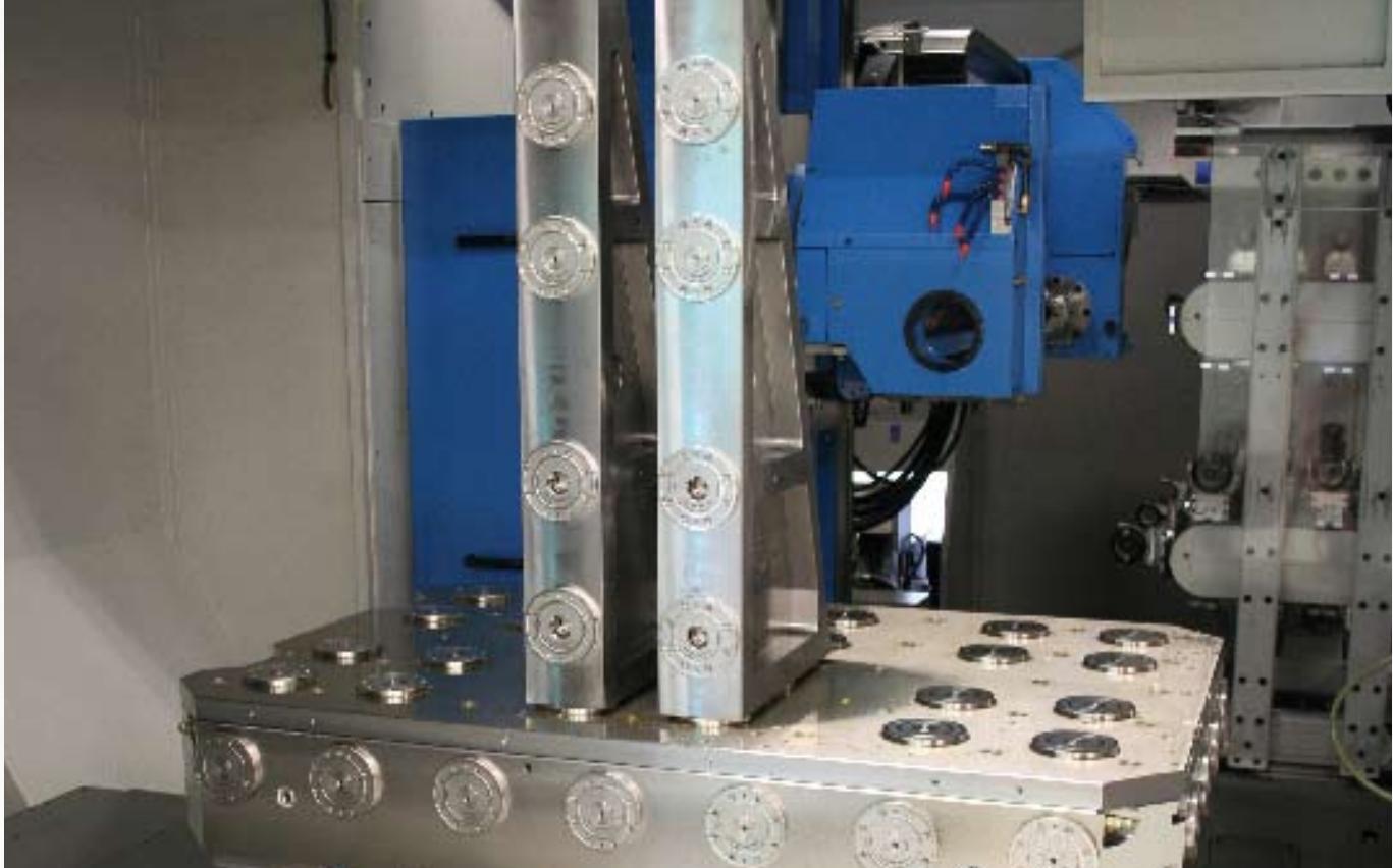
Die AMF-Nullpunktspanntechnik macht zeitaufwändiges Ausrichten der Werkstücke auf Tieflochbohrmaschinen überflüssig.
