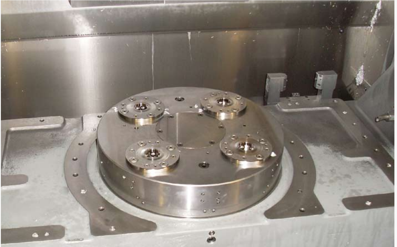
Automatisierungslösung (Best.-Nr. 427161) mit Verriegelungs- und Auflagekontrolle sowie Nippelabfrage im Einsatz in einem vollautomatisierten Fertigungsprozess mit Roboterbeladung.
