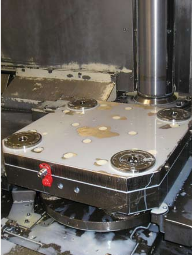
Der Modul-Innenraum ist komplett abgedichtet. Dadurch ist das System vor Flüssigkeiten und Schmutz bestens geschützt
