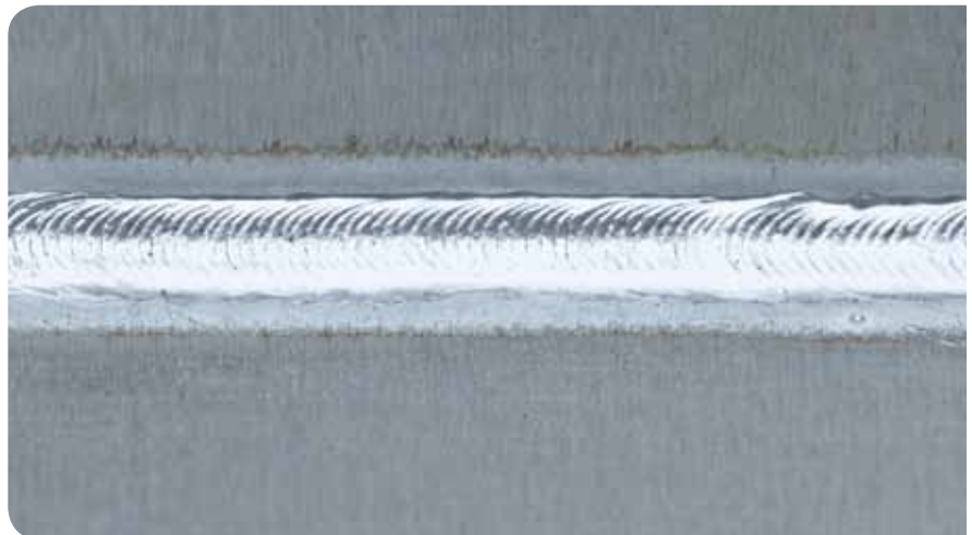
Schweißnaht – z. B. Cold Weld Prozess
